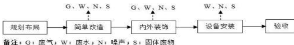
图 2-2 施工期工艺流程及产排污环节图
