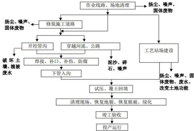
图 2-2 管道及站场施工流程及产污节点示意图
