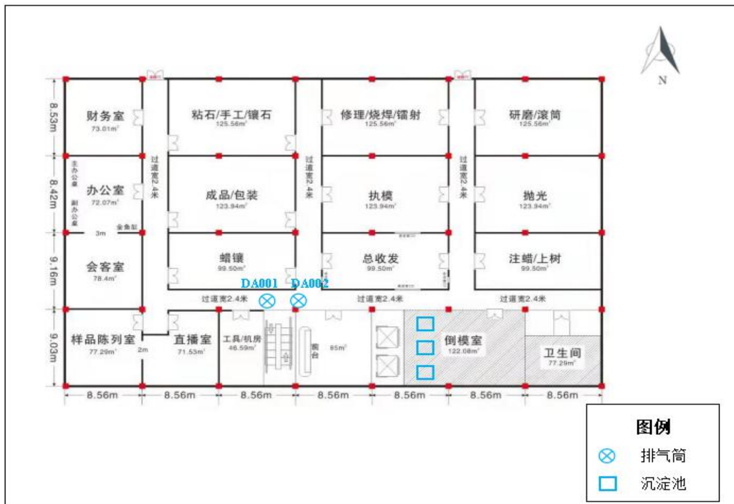
附图2 厂房平面布置及环保设施位置图
